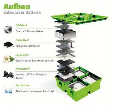
Zwischen der Anode aus Kohlenstoff-Titan-Phosphat und der Kathode aus Manganoxid wandern die Ionen aus dem Salzwasser Elektrolyt und machen den Energiefluss möglich. Durch den Wechsel der Ionen zwischen Anode und Kathode wird die Batterie be- und entladen. Es werden ausschließlich Materialien mit ausreichend Ressourcen verwendet, absolut ungiftige, häufig vorkommende Rohstoffe.
